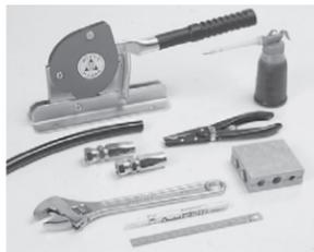
使用条件に適したホースおよび継手、ホースカッター、ホールディングタイ、潤滑油※、モンキーレンチ、白ペンを用意します。
