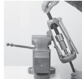
ダイ受け皿の下方の位置で左手でホースを持ち、できるだけまっすぐに継手をプッシャーに押し付けながら、右手で加圧スクリューを時計方向に回転させ、プッシャーを下降させます。その時、ダイの穴に継手端部が一致しているように位置を合わせながら下降させます。
