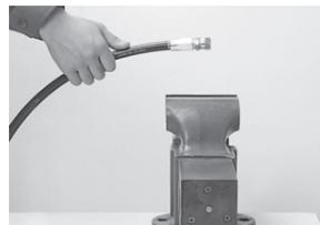
ニップルのねじ込みが完了後、コアチューブに変形がないか貫通棒を継手の中に挿入してご確認ください。アセンブリ終了。
