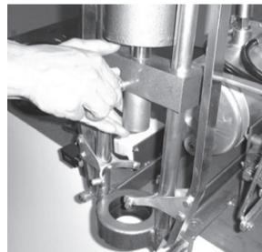
プッシャーホルダにプッシャーを取り付けます。プッシャーが自由に回転する程度にプッシャーホルダのねじを手で回して、プッシャーを固定します。
