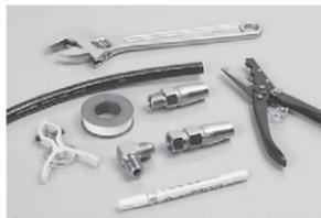
使用条件に適したホース、継手、ホースカッター、白ペン、トルクレンチ、シールテープ、取り外し治具を用意します。
