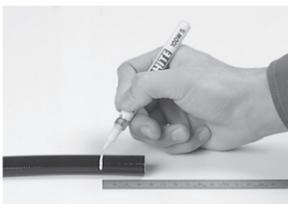
継手に挿入するホース長さをスケールで計り、その位置に白ペンを使ってホースにマークします。
