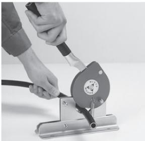
ホースアセンブリ長さからホース切断長さを決定し、切り口が直角になるように専用ホースカッターを使用して切断します。
