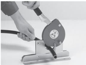
ホースアセンブリ長さからホース切断長さを決定し、切り口が直角になるように専用ホースカッターを使用して切断します。
