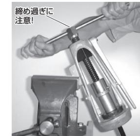
加圧スクリューのハンドルを取り付け、両手で時計方向に回し、プッシャーを下降させます。プッシャーがダイに接触するまで、締め付けてください。
