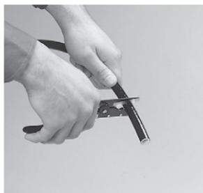
切り口が直角になるように専用ホースカッターを使用して切断します。
