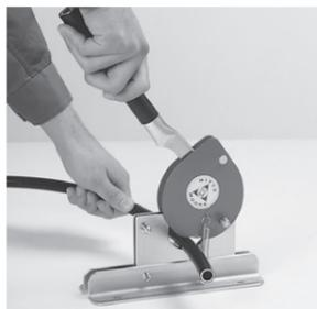
ホースアセンブリ長さからホース切断長さを決定し、切り口が直角になるように専用ホースカッターを使用して切断します。
