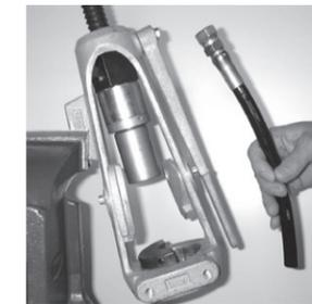
⚠注意 ダイは、内面のゴミ、ほこりを除去し、防錆のため、薄く油を塗布して保管してください。
