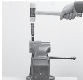
ホース内面に清浄な潤滑油を塗布し、継手をホース挿入長さのマーク位置まで挿入します。
