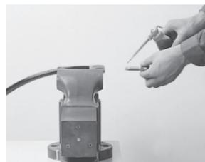
バイスおよびホールディングタイよりアセンブリを取り出します。ソケットをバイスにはさみ、ニップルのねじ部とホース内部に潤滑油を十分に塗布してください。
