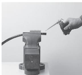
ホースをホールディングタイにはさみ、ソケットにねじ込むホース長さ分だけホールディングタイから突き出して、バイスに固定します。ねじ込みを容易にするため、ホース端部表面に潤滑油を塗布してください。
