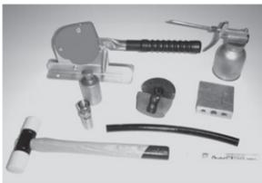
使用条件に適したホース、スウェイジ継手、プッシャー、ダイ、ホースカッター、ホールディングダイ、潤滑油<sup>※</sup>、プラスチックハンマー、スケール、白ペンを用意します。
