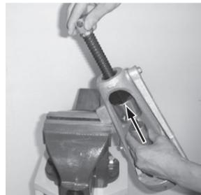
マーク10のリップ部をバイスに固定した後、加圧スクリューを最上部まで上げます。その時、ダイクランプは写真のように開いておきます。
