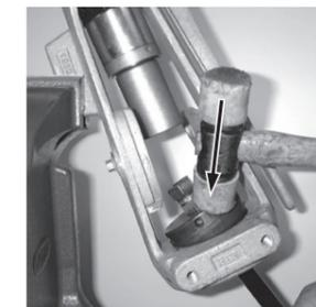
ダイクランプを外し、加圧スクリューを反時計方向に回しプッシャーを上昇させて、ダイからホースアセンブリを取り外してください。取り外しにくい時は、プラスチックハンマーでダイを軽く叩いてください。
