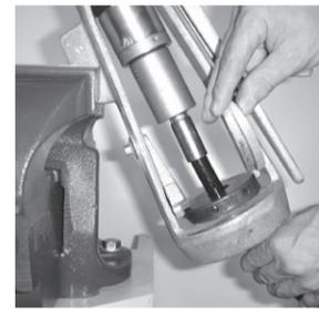
ダイの残りの片方を受け皿に入れ、ダイクランプを回してダイをロックし、しっかりと固定します。
